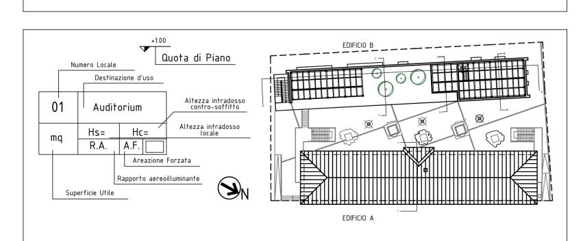
Quota di rifermenti + 20.10 piano finito pavimento Palestra Struttura in ferro e vetro SERRA SOLARE 73.80mq Struttura in ferro e vetro 73.80mq BOTOLA ACCESSO ALTETTO PER RAGGIUNGIMENTO LINEA VITA
