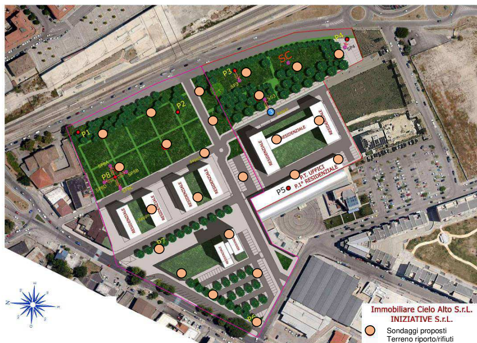
Fig. 8: Proposta punti di indagine per caratterizzazione riporto/ rifiuti
