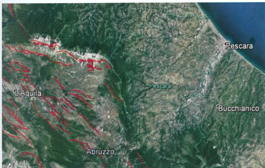
Figura 6 - Ortofoto dell'area con, in rosso, l'evidenza dei sistemi fagliativi attivi e capaci individuati nell'ambito del Progetto ITHACA del Servizio Geologico d'Italia – ISPRA. ( http://sgi1.isprambiente.it/geoportal/catalog/content/project/ithaca.page )
