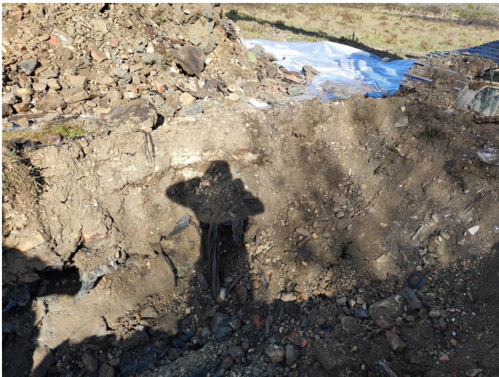
Foto 3 - Trincea TRS13 dettaglio dell'orizzonte di rifiuto.
